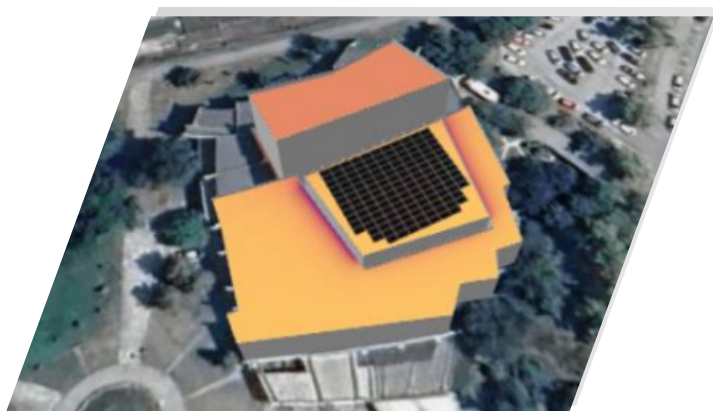
Slika 7. Simulacija solarne elektrane na krovu objekta Doma kulture Prijepolje
