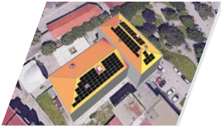
Slika 11. Simulacija solarne elektrane na krovu objekta Gradskog kulturnog centra Užice
